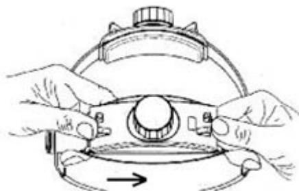
Затем прикрепите mPack UNPLUGGED к тыльной части обруча, придерживая его левой рукой и помещая mPack UNPLUGGED на обруч так, чтобы светодиоды были слева. mPack UNPLUGGED прочно сцепляется с обручем легким нажатием большим пальцем левой руки. Присоедините регулятор яркости к mPack UNPLUGGED.
