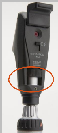
2. Вертикальное колесо на ретиноскопе вращается, чтобы изменить угол световой полосы
